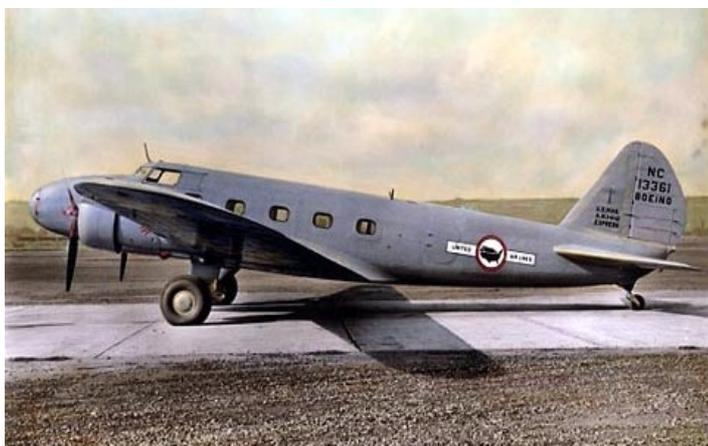
*Model 247, cabine insonorisée et climatisée, doté également d'un système de dégivrage pneumatique des ailes.*
