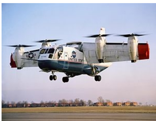
XC-142 A " Tilt Wing " ( l'aile pivote en même temps que le moteur )
